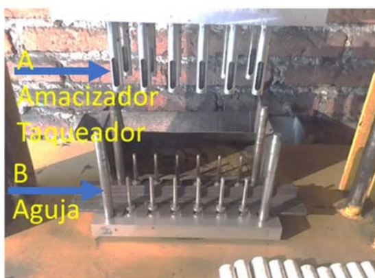
Fig. 2. Piezas que sufren desgaste por fricción.
